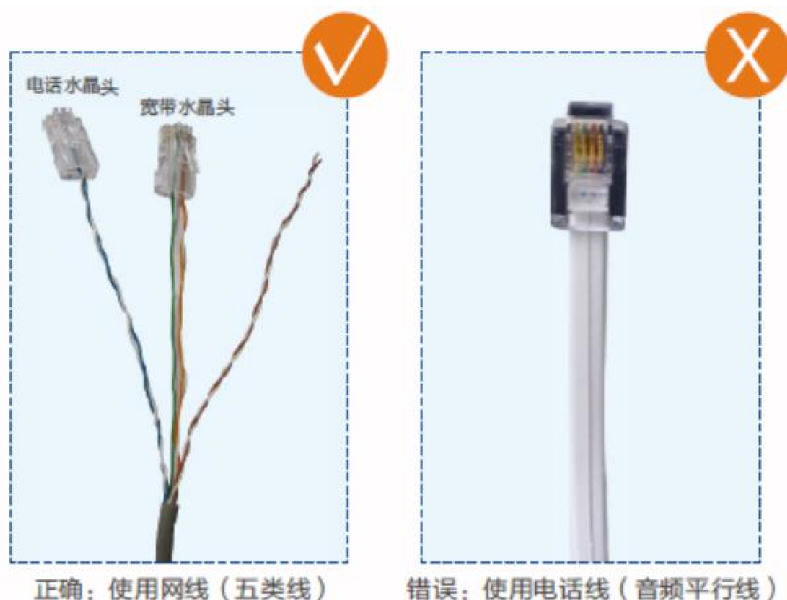
图 2 - 4 线缆选择及接线方式示意图
